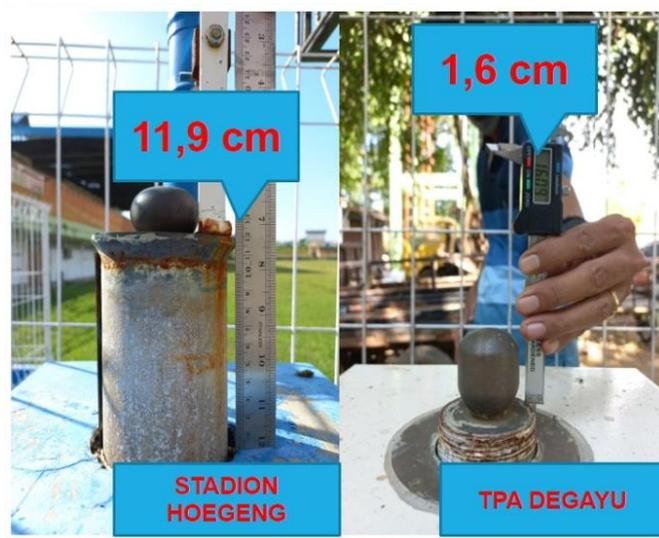
*Gambar 3.4. Alat Ukur Penurunan Muka Tanah*
