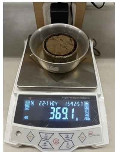
Pengukuran lengas tanah metode gravimetri
