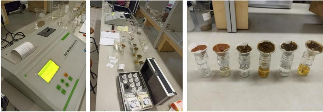
Pengukuran salinitas dan bahan organik menggunakan alat *Soil Nutrient Analyzer*
