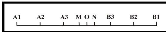
Gambar 2. 3 Konfigurasi elektroda pada Konfigurasi Schlumberger untuk pendugaan vertikal
