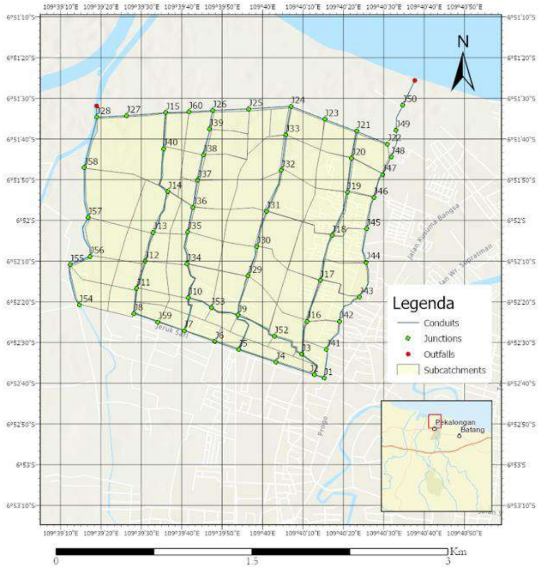
Gambar 4. 14 Skema Drainase dan Subcatchment Bandengan
