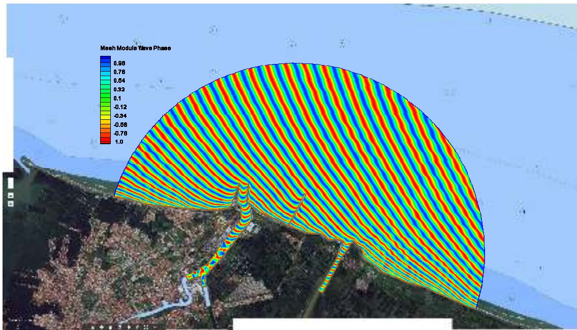
Gambar 4.22 Transformasi Gelombang Gelombang Dominan Datang Dari Arah Utara
