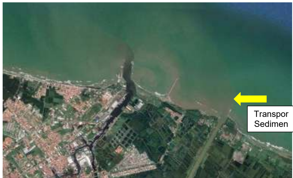
Gambar 5.8 Arah Transport Sedimen Sepanjang Pantai Perairan PPN Pekalongan
