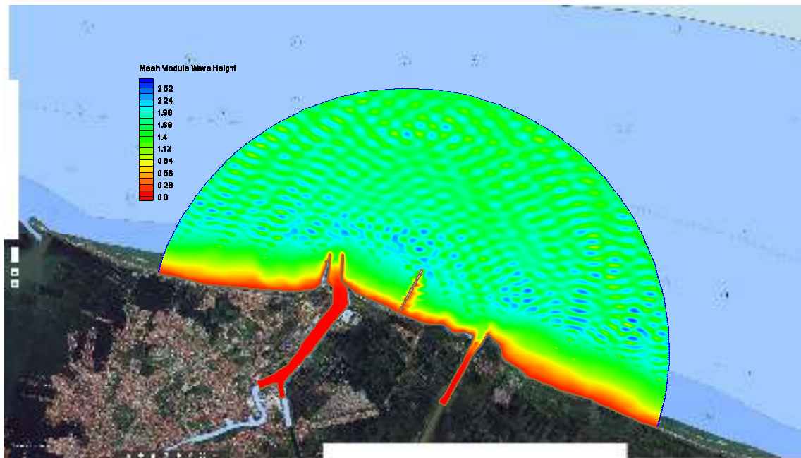
Gambar 4.19 Kontur Tinggi Gelombang Gelombang Dominan Datang Dari Arah Utara
