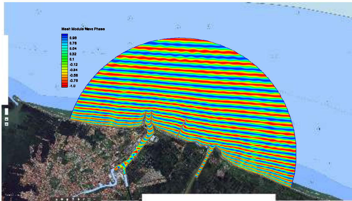
Gambar 4.20 Transformasi Gelombang Gelombang Dominan Datang Dari Arah Utara
